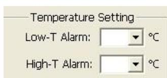
**3.8.1 低温报警温度值:** 室内温度低于该设置值时 **Low Temperature Alarm:** 告警。
